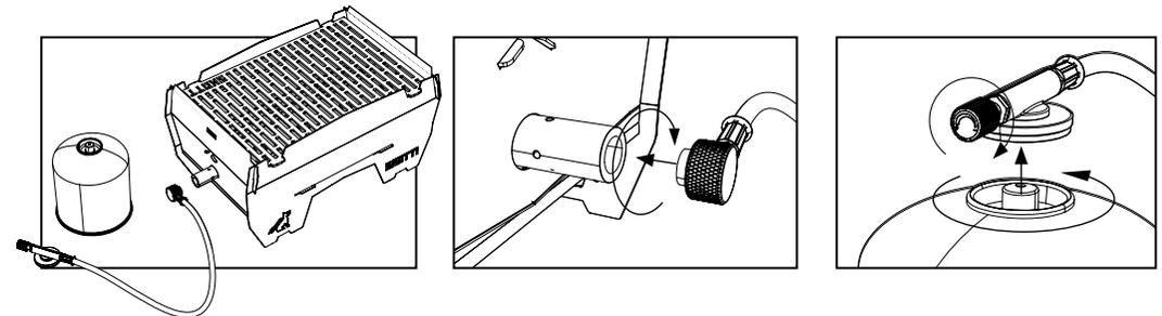
1. Drehe das Ende mit der Gasdüse im Uhrzeigersinn und mit Gefühl auf das runde Brennerrohrende von Skotti. Das Ende sollte fest aufsitzen, ohne viel Kraft anzuwenden.
