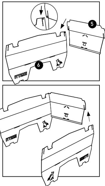
1. Stecke das lange Seitenteil (6) auf der Seite mit Skotti-Logo und das kurze Fußteil (5) mit wabenförmigem Loch an der Verbindungsfuge ineinander. Beide Teile sind an der Verbindungsfuge mit einem kleinen Dreieck gekennzeichnet.
