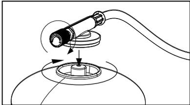
1. Verschließe den Gashahn mit einem handfesten Zudrehen nach rechts (↻), bevor Du die Gaskartusche löst.
