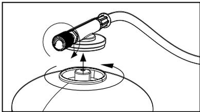
3. Überzeuge Dich vor dem Anschließen, dass die Dichtungen zwischen Skotti und Gaskartusche vorhanden und in einwandfreiem Zustand sind. Verwende Skotti **nie** mit defekten oder abgenutzten Dichtungen.
