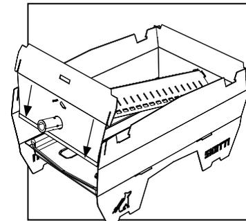
6. Schiebe das Bodenteil (8) so nah an das Fußteil (5) heran, dass die Haken seitlich Halt bekommen und die beiden vorderen Nasen am Bodenteil in die passenden Schlitze des Fußteils gleiten.
